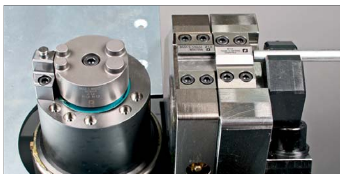
▲ 用于卷绕和弯曲的组合式4轴工具
